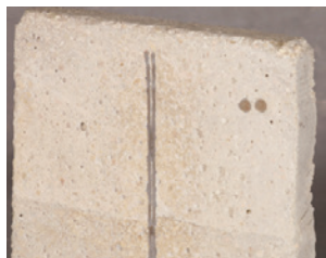
混凝土截面中两块 AQUAFIN-CJ5板复合体
